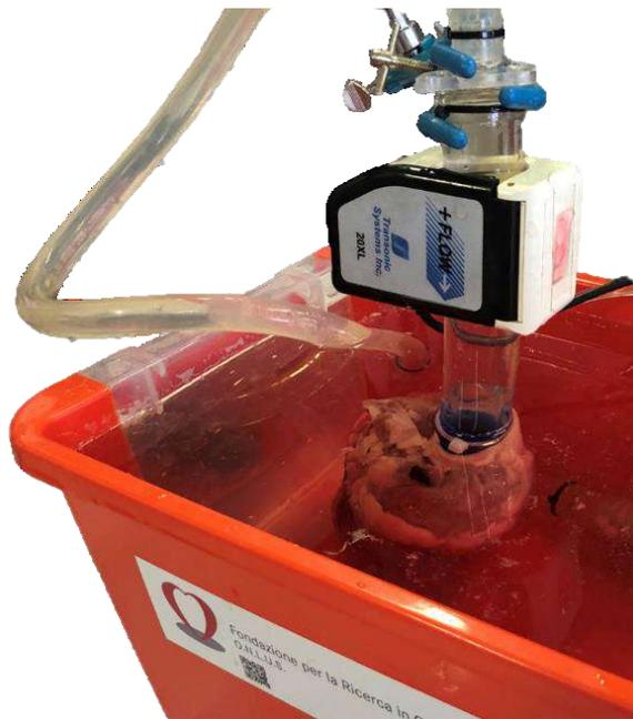
Figura 41. Fotografia del banco del ForCardio Lab utilizzato per pressurizzare il ventricolo.
